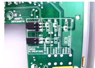
Fig. 11 Detalii privind configurarea jumperilor pentru alegerea modului de alimentare la monitoarele video MCS.4(3)2A
