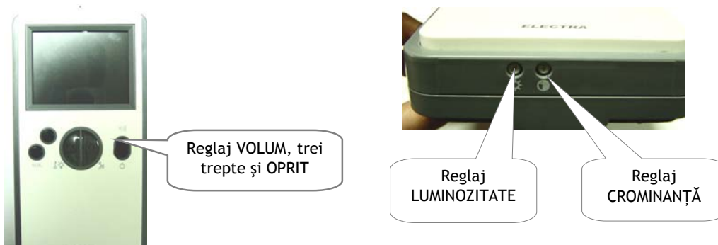
Fig.16 Reglaje externe disponibile la monitoarele MCS.4(3)2A
