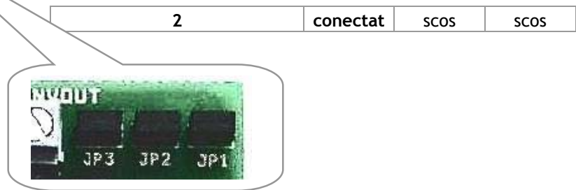
Fig. 12 Detaliu cu jumperii de selecție a intrărilor de semnal video de pe placa distribuitorului de semnal video DSV.41A
