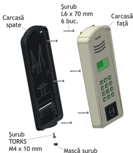
Fig. 2 Instalarea panoului exterior PES.A255
